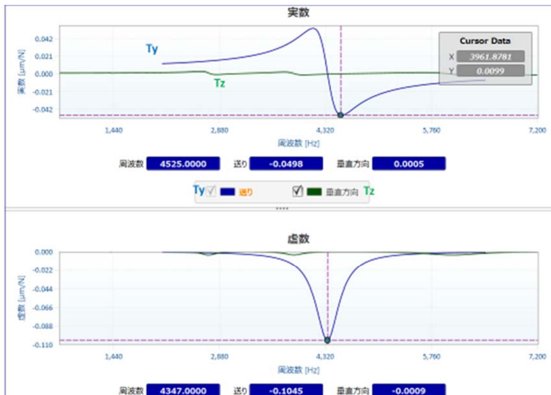
図 6 工具刃先端 Y(切削速度)方向と Z (切込み) 方向の FRF 測定結果
