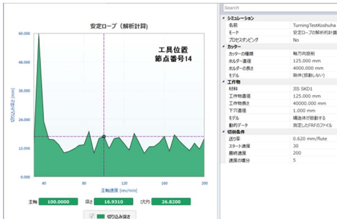
図8 安定限界線図予測計算結果
