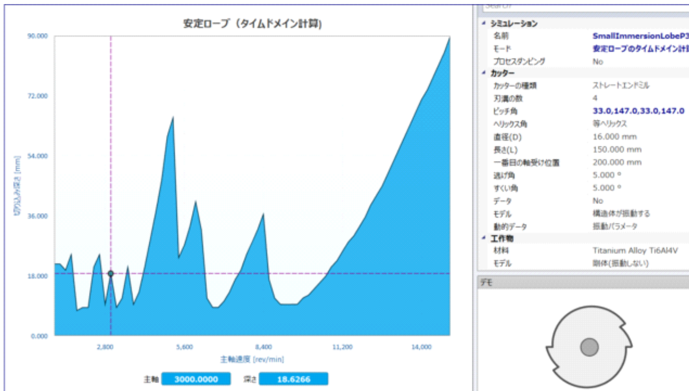
図4 4枚刃のピッチ間隔を33度,147度,33度,147度とした等ヘリックス角(30度)工具の安定限界線図,(半径方向切込み0.5mm ダウンカット)
