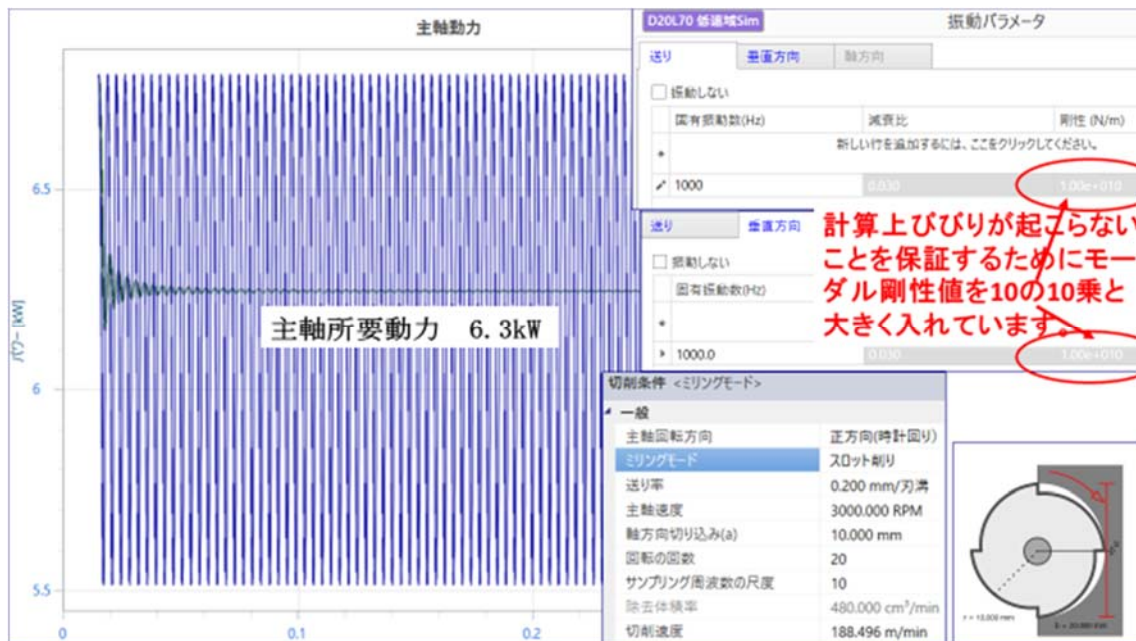
図 1.10 ミリングプロセスシミュレーションによる主軸所要動力の計算結果
